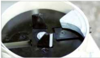
Messerscheibe – große Messerscheibe, 2 Vorschneidmesser, 2 Hobelmesser, Amboss aus Stahlguss.
