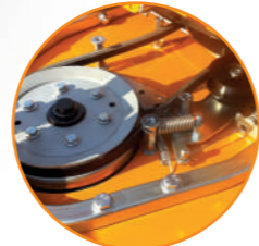
A motor főtengelye és a kés-hajtó tengely külön egységet alkotnak, így ütközés esetén hatékony motorvédelmet biztosít.
