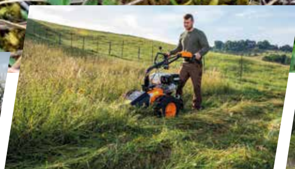
Schonender Schnitt mit Doppelmesser-Mähbalken
